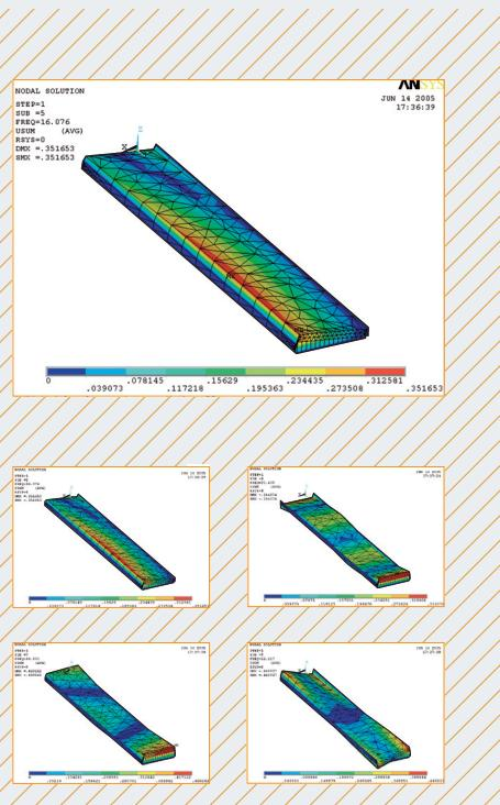
Формы колебаний, вычисленные методом конечных элементов (FEM)
